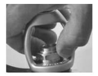
5. A l'aide de la douille A11001, visser le siège d'étrier avec un couple de **25 N-m. / 18.4 ft-lbf.** Visser la vis d'étrier dans l'étrier.
