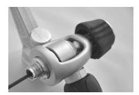
4. Vérifier que le filtre est bien muni de son joint torique et qu'il est toujours en place dans le corps, visser alors le siège d'étrier en le faisant passer au préalable dans l'étrier. Lors de cette étape le corps doit être réalisé avec l'arrivée d'air vers le haut.
